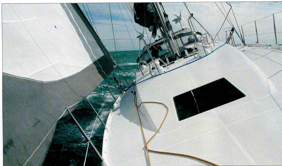
▲ Notez le pavois en aluminium et les emplantures de chandeliers non traversantes. C'est du solide, tout comme le revêtement antidérapant d'excellente qualité.
